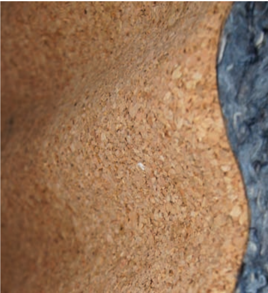
Métisse® thermoformé afin d’acquérir des propriétés d’isolation phonique et floqué d’une couche de liège recyclé.
