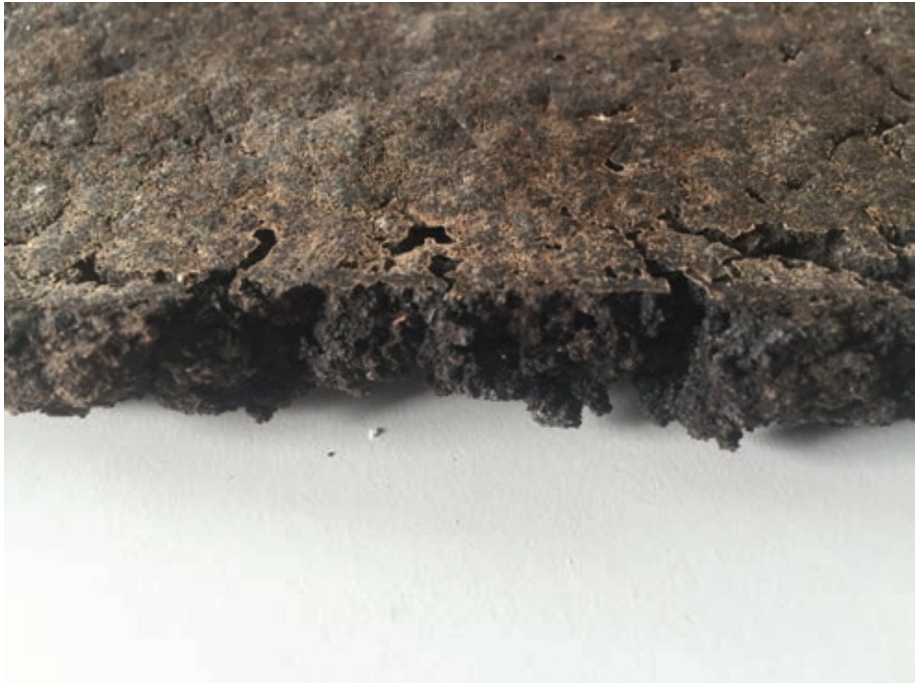
Matériau liant : bio résine, latex plaque de marc de café chargé d'aluminium aggloméré au latex
