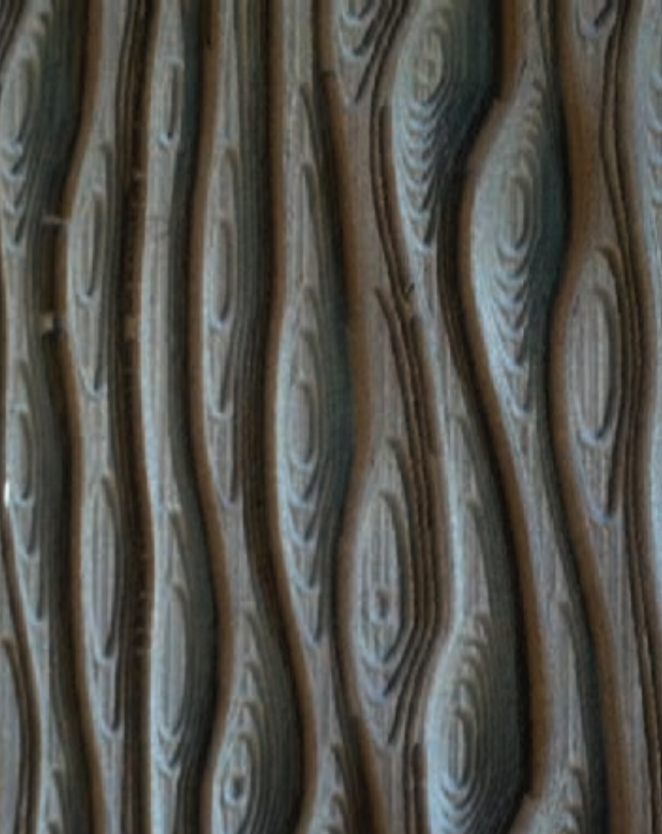
MDF (médium) teint dans la masse, disposant d’un motif évoquant le sable sculpté par l’eau. Matériau utilisé pour ses propriétés phoniques.
